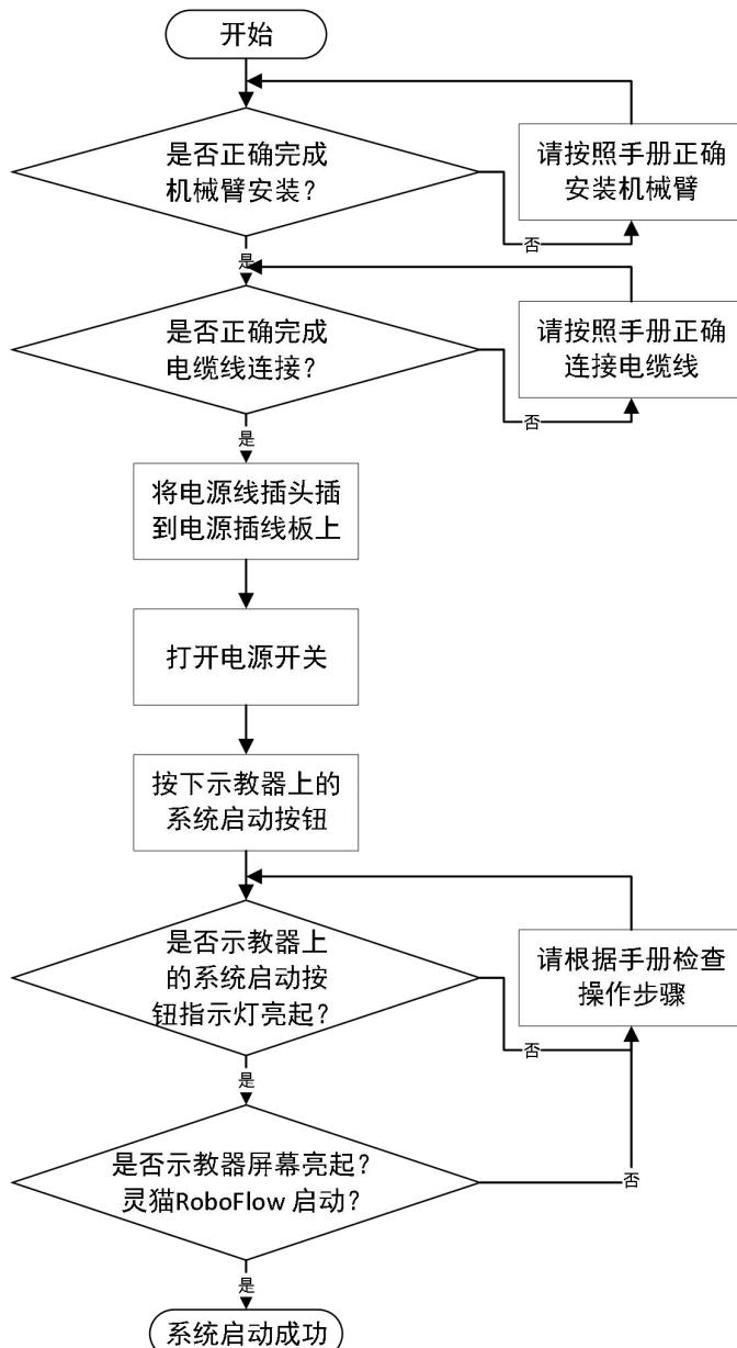
图 3-5 机器人系统开机流程图
