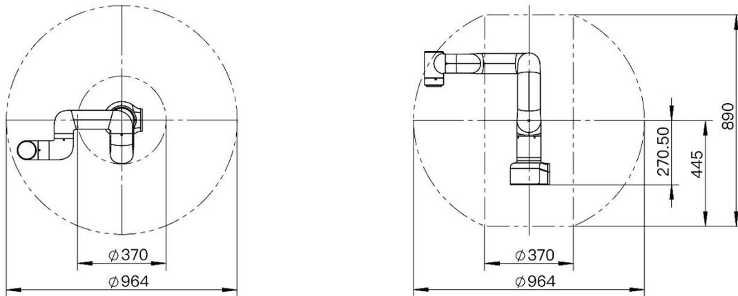
图 2-3 灵猫机器人工作空间示意图
