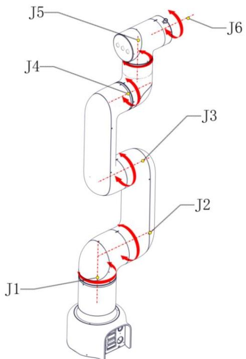
图 2-2 机器人本体示意图
