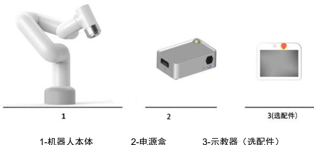
图 2-1 机器人系统组成
