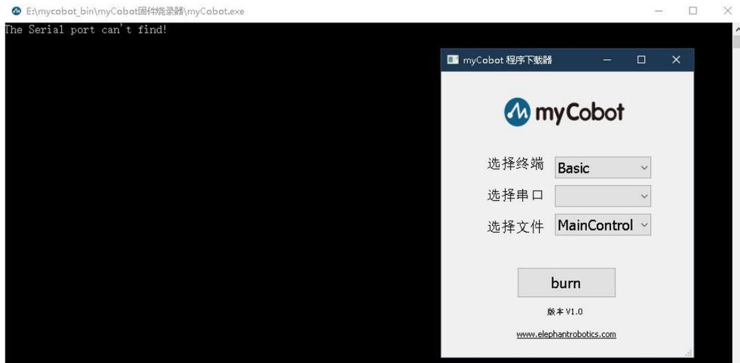
2. 更换中断后未检测到端口变化，无法上传，解决方法为重新打开软件。
