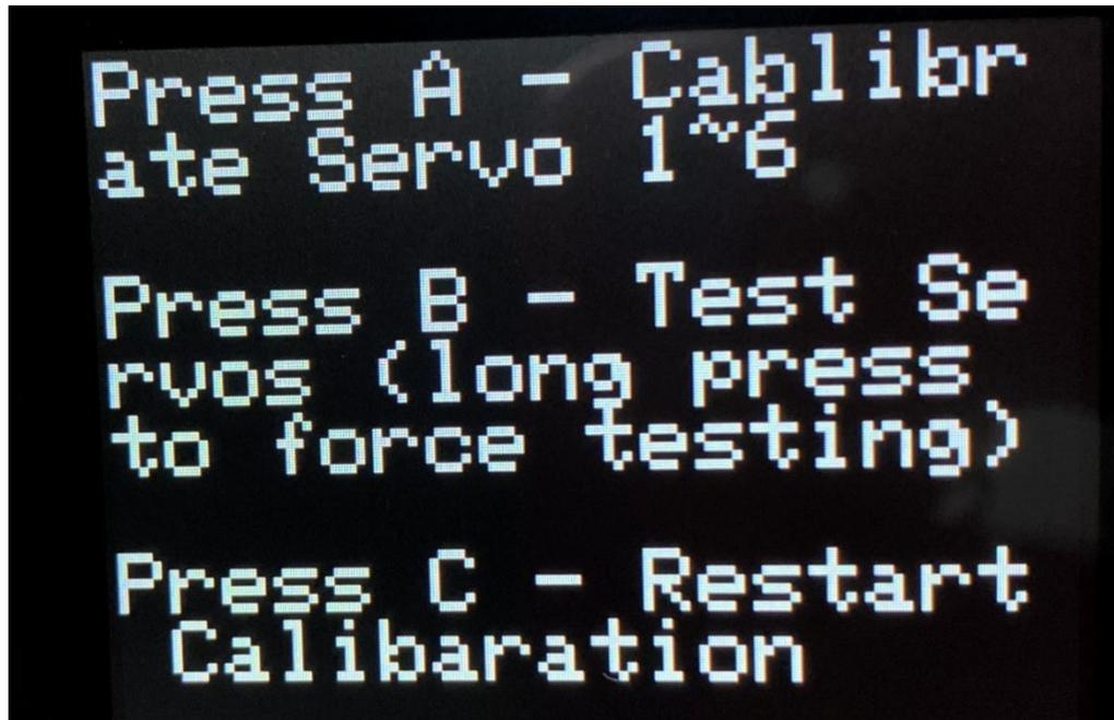
此时，将J1关节转动至标准零位，对准凹槽后按下A键（最左侧按键），J1关节将会上电（上电意味着从随动状态到固定状态）并固定在此标准零位上；根据以上的方法重复这些步骤，依次完成剩下关节的设置；在J6关节设置完成后须再按一次A键来保存所有设置。
