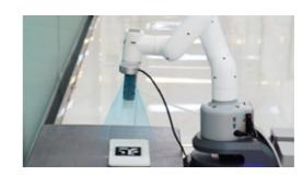
手眼标定 myCobot可进行摄像头精确定位与标定,并进 行大范围内抓取
